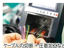
ケーブルの切断・圧着加工など
